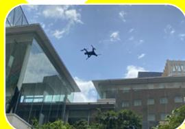
自律飛行型のドローンがあらかじめ設定したルートを飛行。階段の昇降や、柱などの障害物がある場所での自動巡回に成功。今後も実証実験を通し、自動巡回警備の本格運用を検討する方針です!
