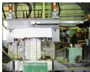
袖壁付き柱の実験状況
