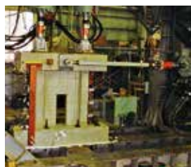
有開口耐震壁の実験状況
