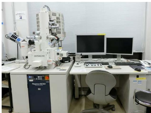
金属、粉末、生物試料等表面微細構造を観察できる装置です。試料に電子線を照射し、新たに試料から放出される二次電子線、反射電子線を検出することにより高倍率で鮮明な立体画像が得られ、さらに、元素特有の X 線をエネルギー分散型 X 線分析装置(堀場製作所／X-Max)で検知することで、5B～238U までの元素を定性・定量分析できる装置です。
