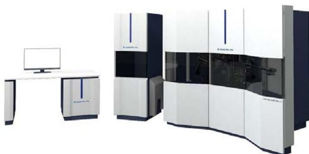
X 線光電子分光法は、固体試料に X 線を照射することにより表面の深さ～10 nm から放出される光電子のスペクトルを測定し、表面の組成並びに化学結合状態に関する情報を得る手法です。本装置は、直径 10um～200um の X 線ビームを 1.4 mm まで走査することができる走査型 X 線光電子分光分析(XPS)装置です。加えて絶縁物試料の測定が可能で、各種 Ar イオン銃により有機物/無機物への高速イオンエッチング銃を搭載することにより優れた深さ方向分析にも対応しております。その他のオプションとしても紫外光電子分光分析、低エネルギー逆光電子分光分析などのオプションを搭載しており半導体試料のバンドギャップ測定も可能です。
