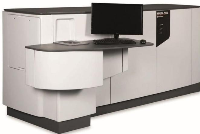
化合物・ペプチド・タンパク質をはじめとした分子の質量分析を高感度に行うことができる装置で、主に合成化学・生物化学の研究分野でよく利用されています。サンプルを含むマトリックスに対してレーザーで照射し、分子をイオン化することにより、分子量・数百 Da の化合物～分子量 500 kDa のタンパク質などのサンプルの分子量を決定することができます。さらに高精度のイオン選択による CID-MS/MS 測定により信頼性の高いプロテオーム解析が可能です。
