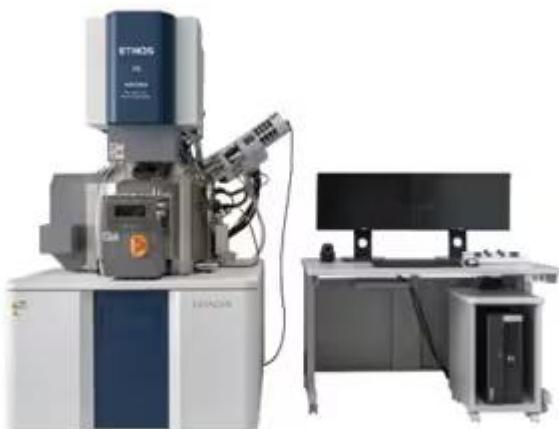
「収束イオンビーム(FIB)－走査電子顕微鏡(SEM)複合装置(以下、本装置)」は、イオンビームを照射する FIB と電子線を照射する SEM の両方の機能を同時に利用することができる最新の電子顕微鏡である。FIB ではイオンビームの照射による①像観察、②加工(スパッタリング)③析出(デポジション)機能がある。①像観察では、集束したイオンビームで試料表面に発生する二次電子などを画像化でき、②加工では、イオンビームで任意の場所を微小加工し、試料の断面や薄膜の作製ができ、③析出では、特定の化合物ガスとイオンビームでデポジション膜を形成することができる。SEM では、①像観察(高解像度)とエネルギー分散型 X 線分析(EDX)を併用して④元素分析ができる。これらの機能複合により、試料の断面形成加工と高解像度断面観察が同時にでき、さらには連続断面像や連続 EDX 面分析を集約・再構成して、形態や組成分布を3次元表示(3次元再構築イメージング)することが可能となる。
